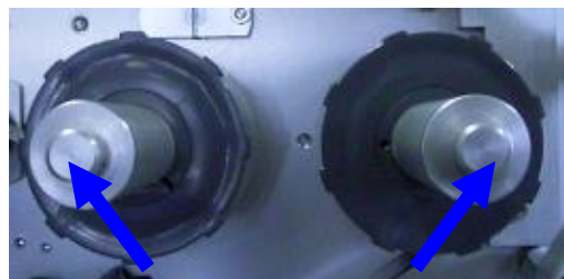
⑥ リボン巻き取り摘み ・ リボンブレーキ摘み 時計回り-強 反時計回り-弱
